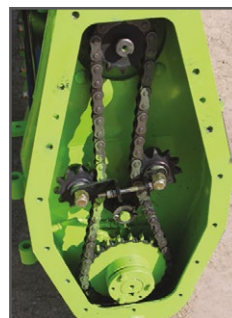
Uzavřený řetězový převod se silným řetězem
